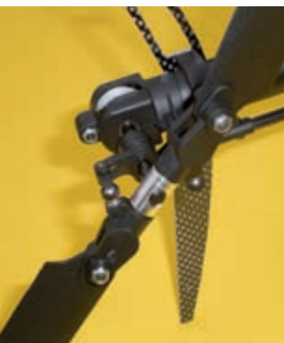
Heckrotor mit zarter Carbon-Seitenfinne
