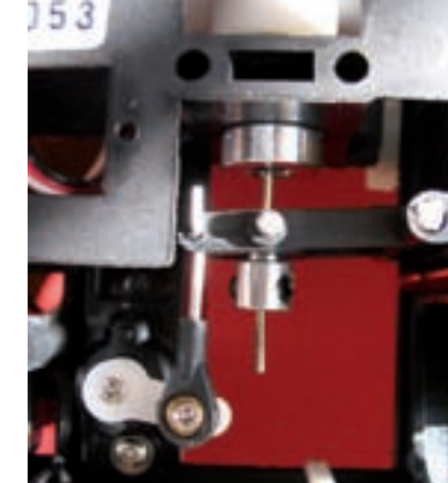
Die Pitch-Anlenkung ist voreingestellt und bedarf keiner Korrektur
