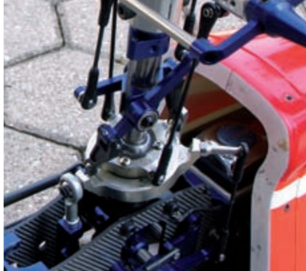
Die elektronisch gemischte 135-Grad-Anlenkung der Taumelscheibe
