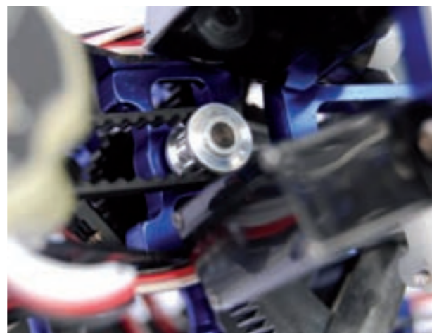
Verschleißarmer Riemenantrieb für den Heckrotor
