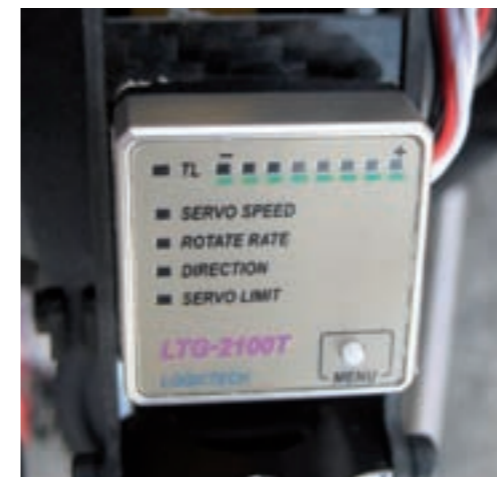
Als Kreisel kommt beim Testmodell ein LTG 2100 zum Einsatz
