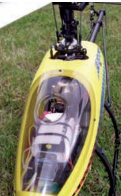
Kontrollzentrum: Kreisel, Empfänger und Motor inklusive Frischlufttrichter
