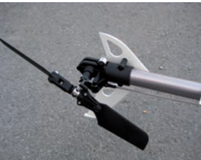
Der Heckrotor wird über einen Riemen angetrieben. Das Heckrotorgehäuse ist geschlossen
