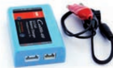
Einfaches Ladegerät mit Balancer-Funktion
