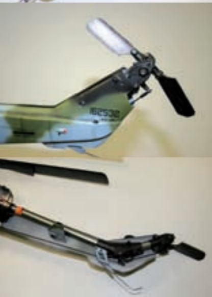
Technik die begeistert: Der Heckausleger ist nicht mehr gerade wie beim original Mini Titan. Wie bei der echten Cobra ist das Heck nach oben gesetzt. Der Antrieb erfolgt über einen umgelenkten Riemen
