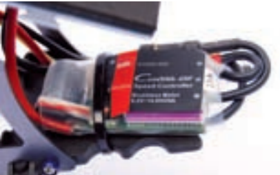
Der mitgelieferte 25-Ampere-Brushlessregler wird unterhalb der Akkuaufnahme befestigt
