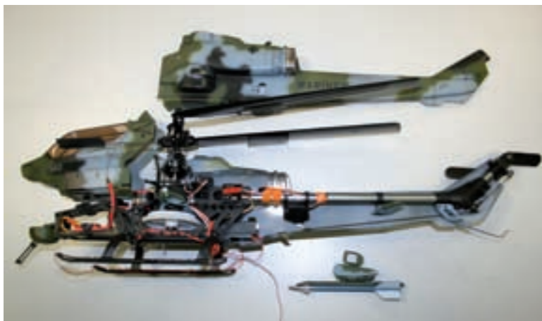
Die Mechanik im Querschnitt. Der Empfänger ist nicht mehr seitlich, sondern mit einer Halteplatte im Inneren der Mechanik untergebracht. Mit nur wenigen Schrauben lässt sich der Rumpf so abnehmen.
