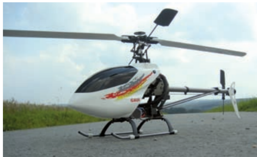
Der Heckrotor wird über einen Riemen angetrieben. Das Heckrotorgehäuse ist geschlossen
