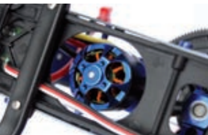
Der Brushlessmotor bleibt aufgrund der großen Ausfräsungen im Läufer immer schön cool
