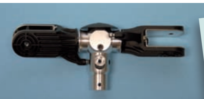
Der herstellereitig vormontierte Hauptrotorkopf mit Blechverstärkungen an den Kunststoff-Blattgriffen
