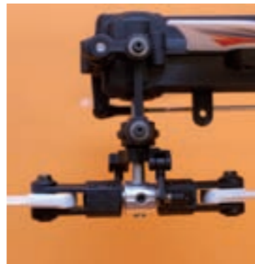
Der komplette Heckrotor mit seinen doppelten Anlenkungen und den nicht ganz gleichgewichtigen Kunststoffblättern
