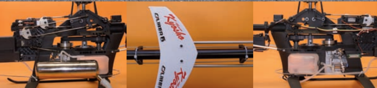
Push & Pull-Anlenkungen, der Kreiselsensor und der Kompaktschalldämpfer aus dem Hause Zimmermann
