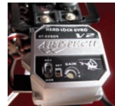
Das Gyro ist vorjustiert, kann aber bei Bedarf auch anders eingestellt werden. Es arbeitet exakt
