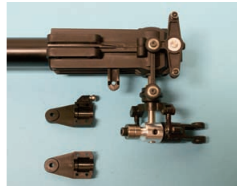
Gut zu erkennen sind die Komponenten des Heckrotors mit der 5 Millimeter messenden Heckrotorwelle und den zweiteiligen, jeweils doppelt kugelgelagerten Kunststoff-Blatthaltern
