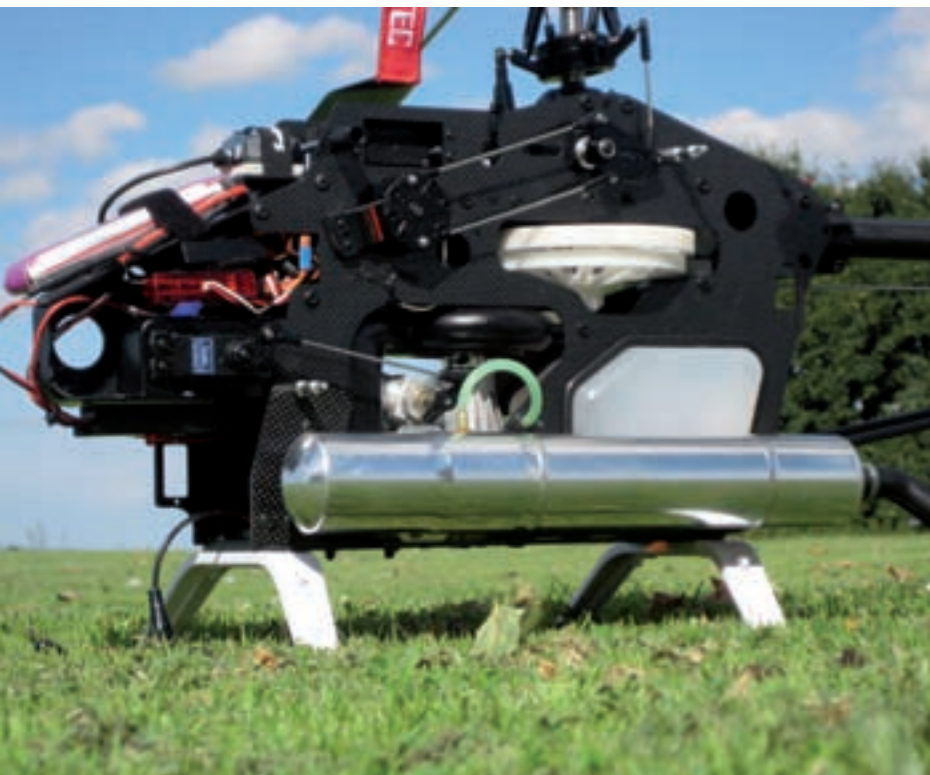
Der Chassis-Aufbau ist T-Rex-typisch. Der Helikopter ist vorbereitet für den Antrieb mit einem 15-Kubikzentimeter-Verbrennungsmotor, hat ein Carbon-Chassis, Heckstarrantrieb mit Drucklagern im Heckrotor, GFK-Haube und 120-Grad-Taumelscheibenanlenkung
