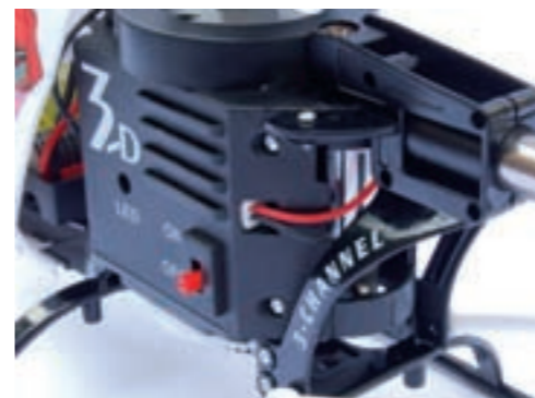
Die Motoren wurden in den Rumpf integriert und bekommen dank der offenen Konstruktion viel Kühlluft
