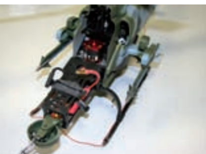
Die vordere Rumpfverkleidung ist ohne Schrauben abnehmbar, damit die Akkus schnell gewechselt werden können. Am vorderen Teil der Akkuaufnahme ist das MG befestigt
