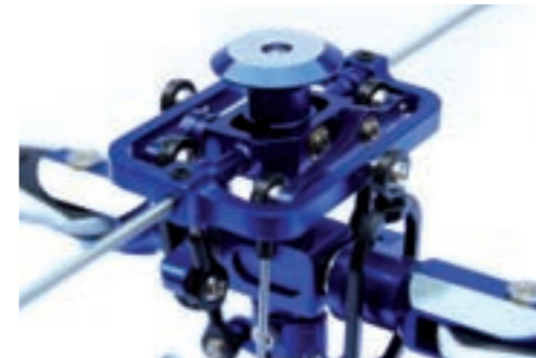
Der großzügig dimensionierte Anlenkrahmen für die Hillerpaddel sorgt für spielfreie Umsetzung der Steuereingaben
