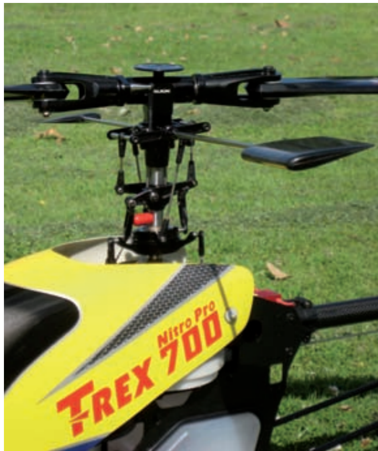
Der Rotorkopf ist vollständig aus Alu gefertigt und komplett kugelgelagert. Er arbeitet völlig spielfrei und ist trotz seiner massiven Bauweise sehr leicht
