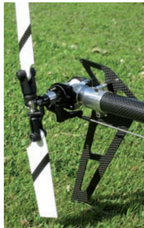
Heckrotornabe und Blatthalter sind annähernd baugleich mit dem T-Rex 600 Nitro
