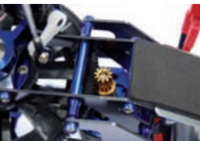
Saubere Verarbeitung der einzelnen Komponenten. Alle Schraubverbindungen sind ab Werk mit Sicherungslack gegen Vibrationen geschützt
